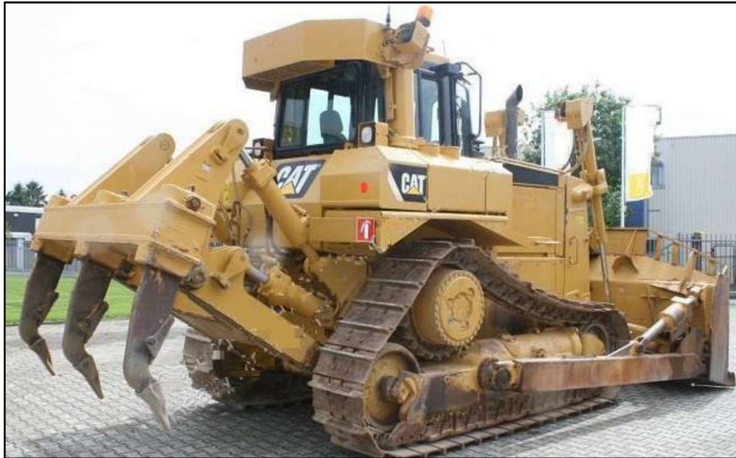
Foto N° 10. Bulldózer tipo D-8 con el Desgarrador o Ripper de tres dientes en la parte trasera.
