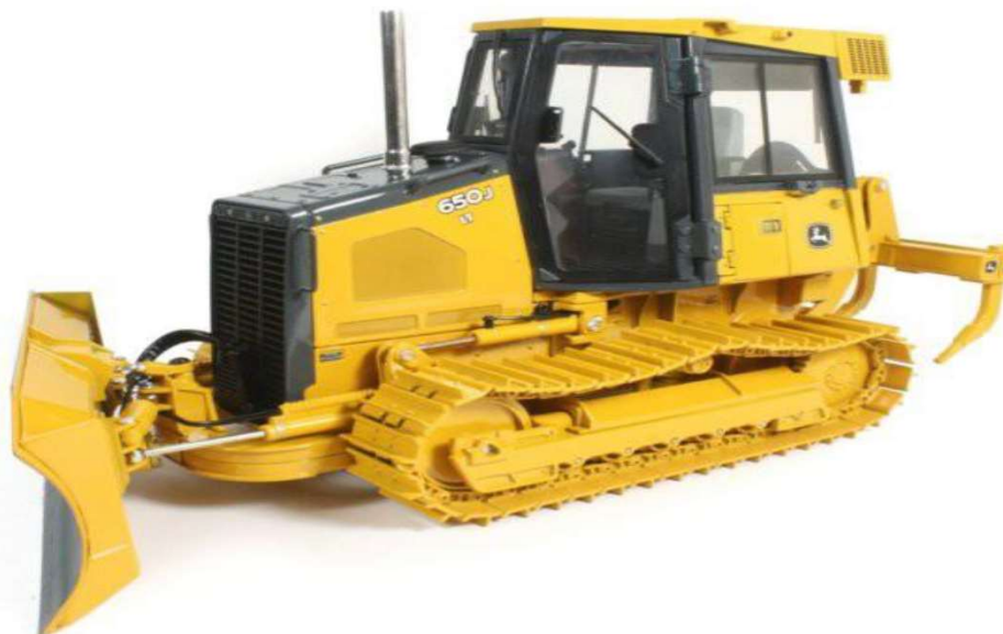
Foto N° 6. Bulldózer con la Pala u Hoja de Empuje en posición Angledozer
