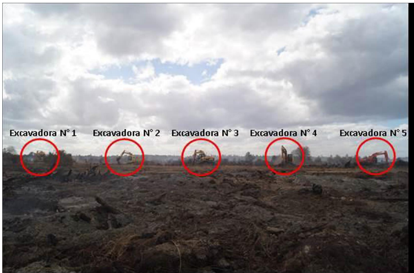
Foto N° 51. Organización y operación de trabajo de extinción con de cinco Excavadoras, en un extenso incendio subterráneo, en esta actividad tiene que haber contacto visual entre los operadores de la máquina, avance en un solo sentido, y puede ser supervisada por un solo técnico guía de CONAF.
