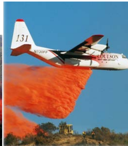
Hércules C-130 con estanques internos
