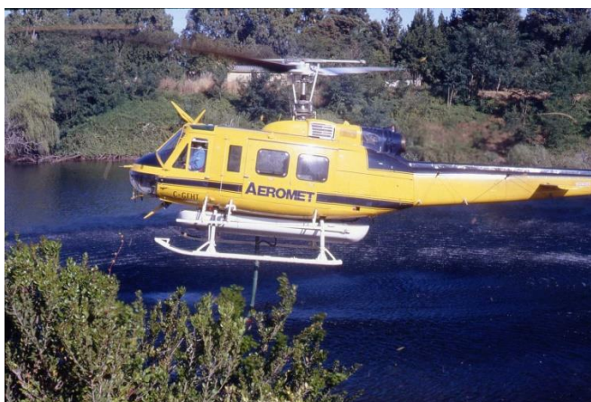
Bell 205 Helitanker auto cargándose agua en una laguna natural (Foto del autor)
