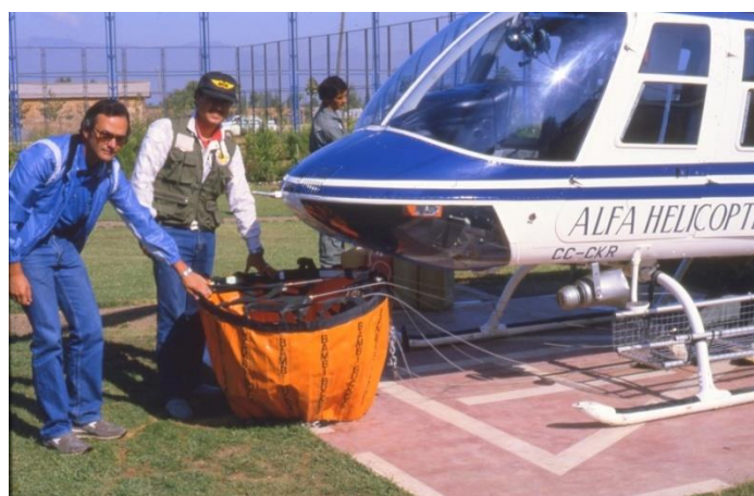
Primer helibalde Bambi-Bucket operado en Chile en un Bell 206 Jet Ranger III, VI Región (Foto del autor)
